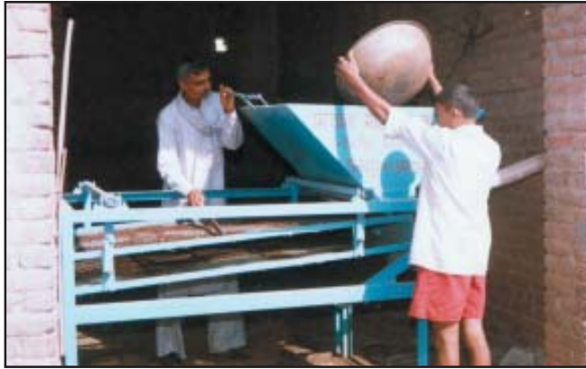
चित्र 21. स्वचालित झारने से वर्मीकम्पोस्ट की छाई
